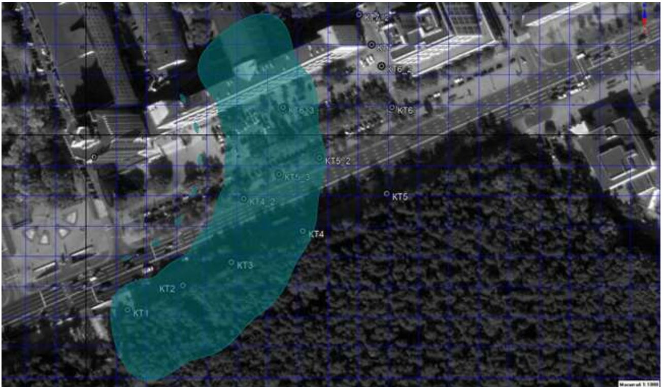
Рисунок 1. Изображение санитарно-защитной зоны БС 5G при ее опытной эксплуатации в Минске. В выделенной области наблюдается превышение уровнем ЭМП БС 5G принятого в Беларуси ПДУ ЭМП 0.1 Вт/м 2 . Анализ выполнен для периода наибольшей нагрузки системы 5G СС при работе БС в режиме динамических лучей БС с мощностью ЭМИ в луче 200 Вт.
