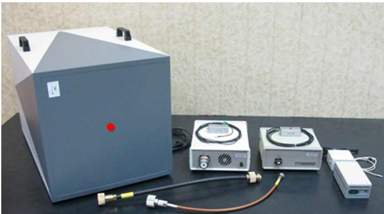
**Рис. 1. Мобильный испытательный комплекс СШП ЭМИ**
