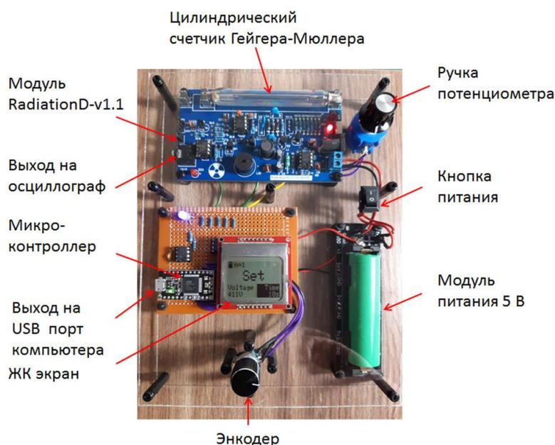
Рис. 2. Внешний вид лабораторной установки
