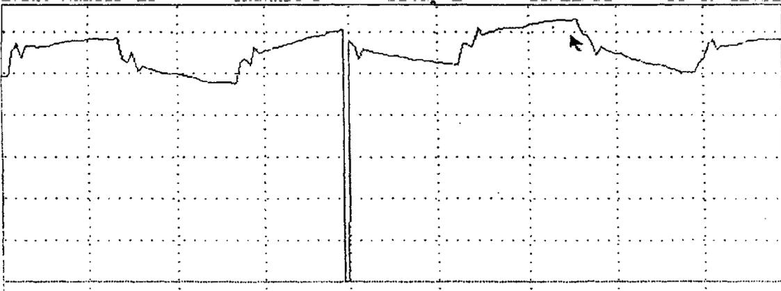
Рис. 1. Колебания и прерывания напряжения питания постоянного тока на ОРУ-750.
