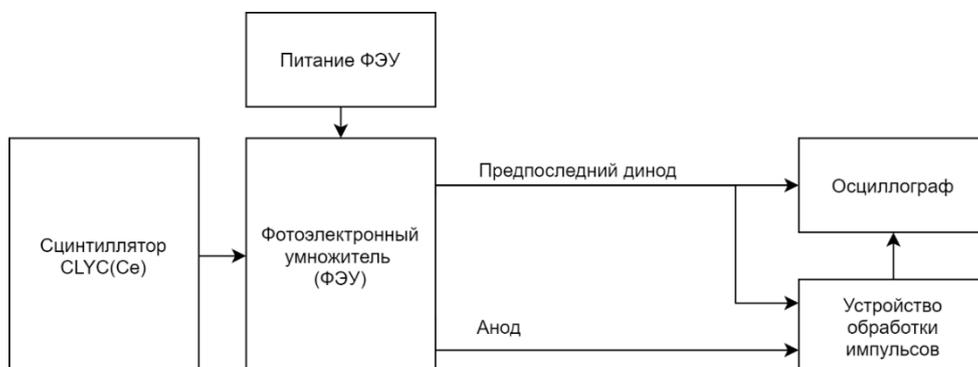
Рис. 1. Структурная схема стенда захвата импульсов сцинтиллятора CLYC(Ce).
