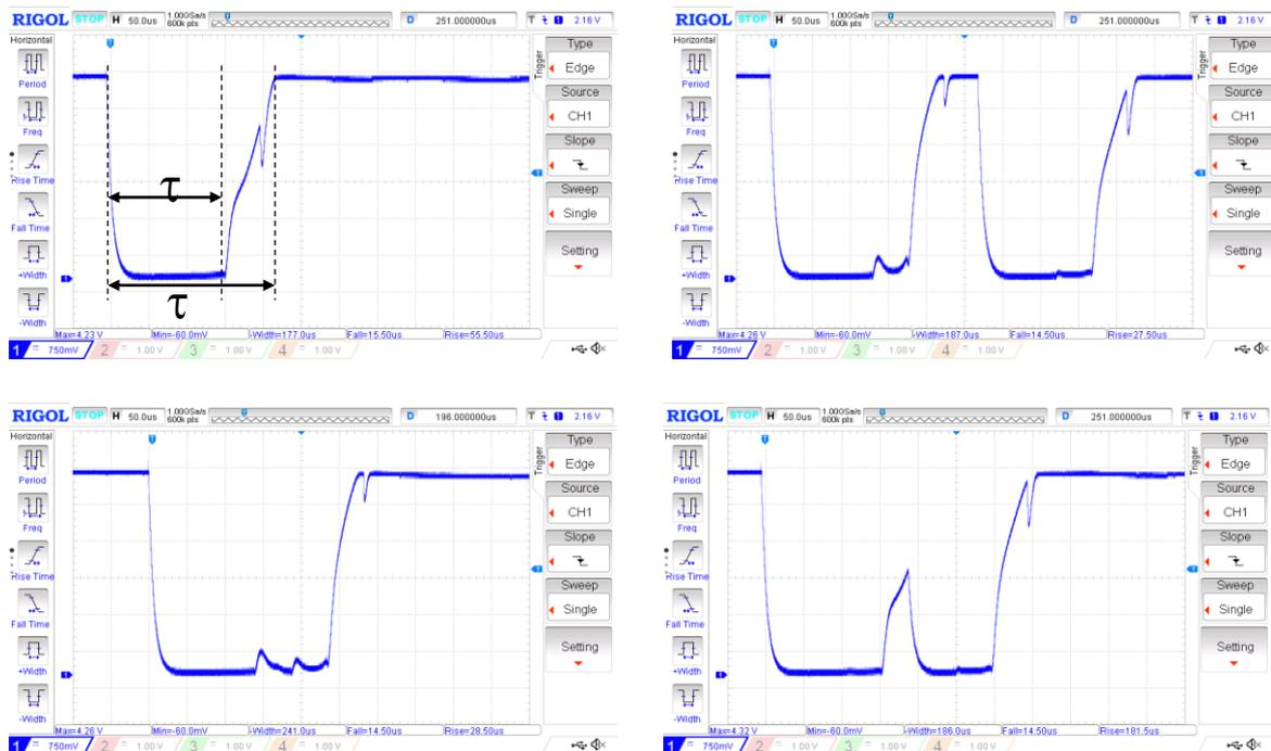
**Рис. 4.** Временная развертка импульсов напряжения на счетчике Гейгера-Мюллера при регистрации частиц (рабочее напряжение счетчика 400 В, скорость развертки сигнала на осциллографе 50 мкс/дел, масштаб по вертикали 750 мВ/дел):
