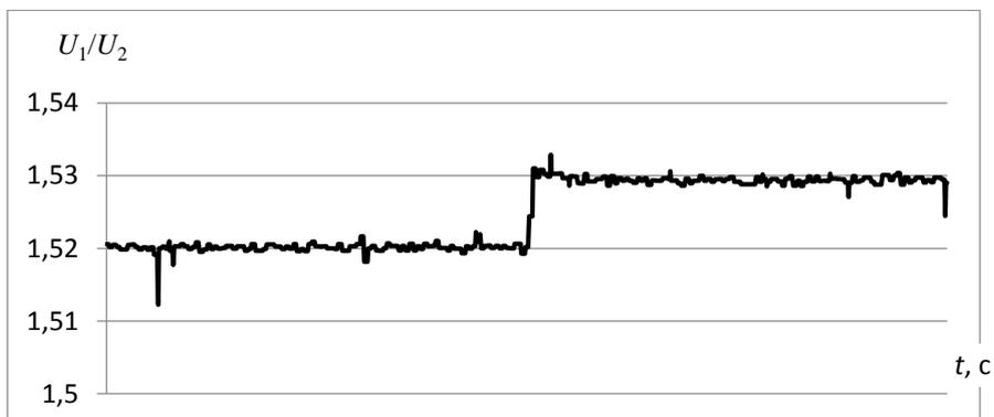
Рис. 6. График зависимости отношения напряжений при МКЗ
