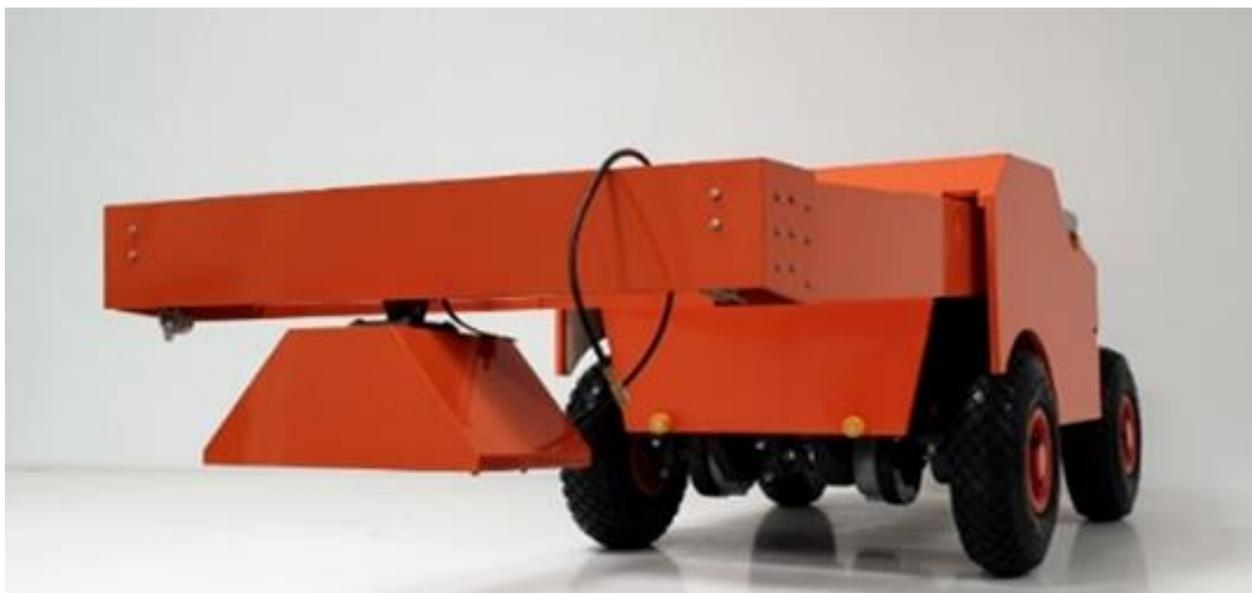
Предназначен для поиска заглубленных объектов (диэлектрических и металлических) и определения глубины их залегания. Позволяет визуализировать внутреннюю структуру строительных конструкций, обнаружить различные дефекты (трещин, воздушных полостей) в дорожном покрытии.
