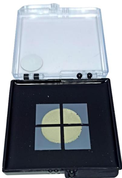
**Применение:** детектирование и исследование структуры химических соединений в субмолярных концентрациях, входящих в состав жидких и газовых сред, для решения задач материаловедения, медицинской тераностики, фармацевтического анализа, криминалистической экспертизы, мониторинга состояния окружающей среды и т.п.
