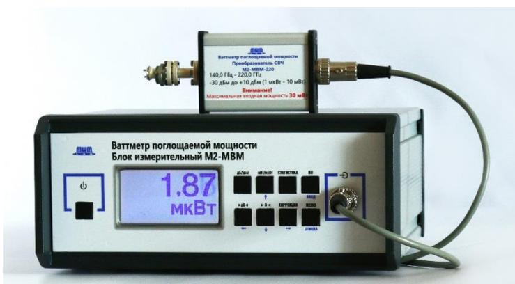
**Назначение:** измерение поглощаемой мощности непрерывных сигналов в диапазоне частот 78,33 – 118,10 ГГц.
