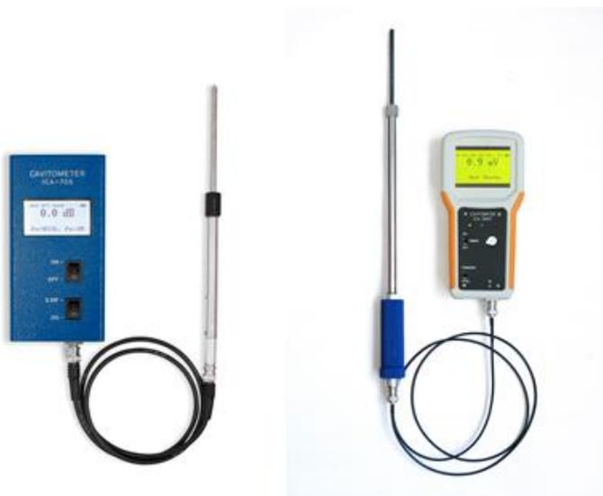
**Назначение:** исследование процессов кавитации и кавитационных эффектов в жидкостях, расплавах металлов и биологических тканях, а также для измерения и контроля активности кавитации.
