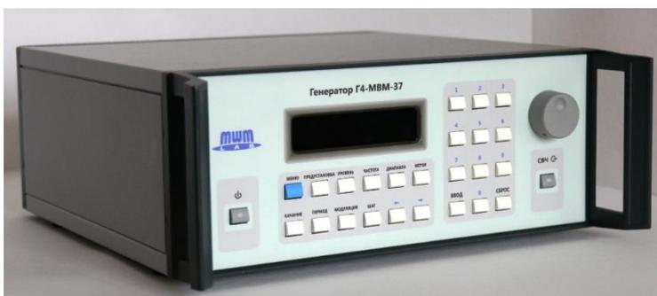
**Назначение:** генерирование колебаний сигналов сверхвысоких частот (СВЧ) в режимах непрерывной генерации на одной частоте и перестройки частоты в диапазоне частот 25,95 – 37,50 ГГц.
