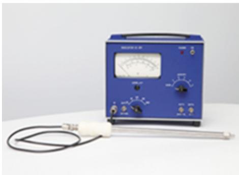
**Назначение:** данный кавитометр может использоваться для оптимизации ультразвуковых технологических процессов, определения наличия и интенсивности кавитации в гидравлических системах, измерения порогов кавитации.
