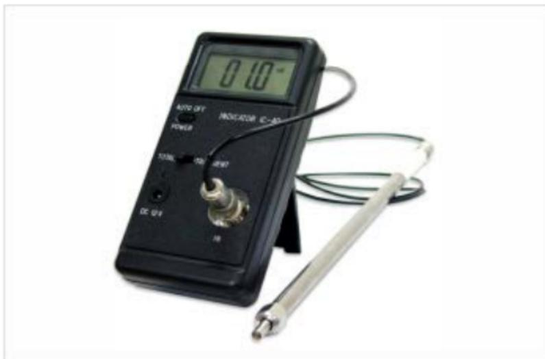
Назначение: предназначен для измерения и контроля активности кавитации в мощных ультразвуковых полях и гидродинамических кавитаторах.
