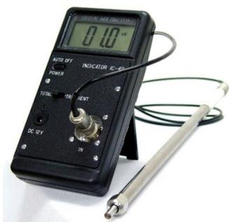
Предназначен для измерения и контроля активности кавитации в мощных ультразвуковых полях и гидродинамических кавитаторах. Прибор можно использовать для оптимизации ультразвуковых технологических процессов, определения наличия и интенсивности кавитации в гидравлических системах, измерения порогов кавитации.
