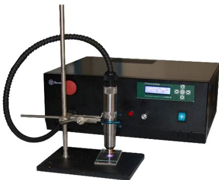
Экспериментальная система генерации плазмы диэлектрического барьерного разряда с применением "холодной" плазмы была разработана для исследования процесса воздействия атмосферной плазмы на биологические объекты и биоорганические вещества, в частности, на семена и корневые системы высших растений. Также возможно использование прибора в косметологии и медицине.
