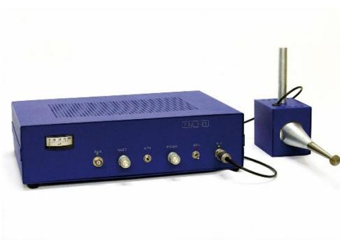
Предназначен для генерирования ультразвуковых колебаний в жидкостях. Прибор может быть использован для получения суспензий или эмульсий из различных веществ, отмывки мелких деталей от механических загрязнений, экстрагирования, диспергирования и в звукохимии, а также для обработки образцов из волокнистых, кристаллических, порошкообразных и других веществ при электронно-микроскопических исследованиях.
