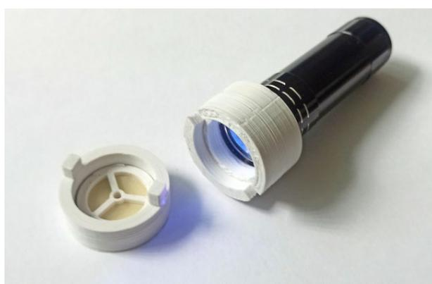
Разработанные фильтры предназначены для многократного использования, обеспечивают фильтрацию частиц размером более 100 нм и стерилизацию бактерий при воздействии солнечного и искусственного излучения, что невозможно при использовании стандартных медицинских масок.
